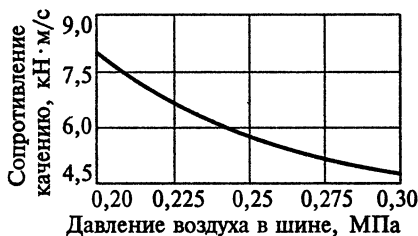
Рис. 19.7. Зависимость сопротивления качению автомобиля от давления воздуха в шине (лабораторные испытания)
