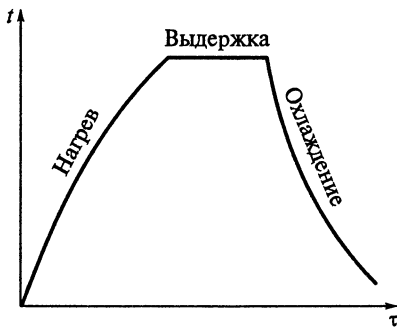
Рис. 2.1. Схема термической обработки:
