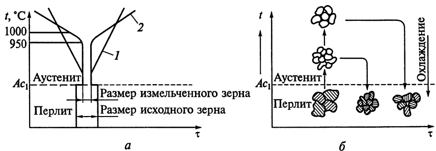
Рис. 1.14. Схема роста зерна аустенита для разных сталей (а) и влияния превращений на размер зерна (б):
